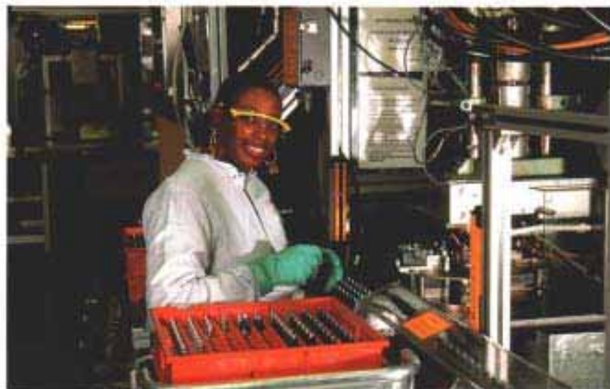
Die USA sind unser bedeutendster Auslandsmarkt. Im Bild die Montage von Benzin-Einspritzventilen im Werk Charleston/South Carolina der Robert Bosch Corporation.
