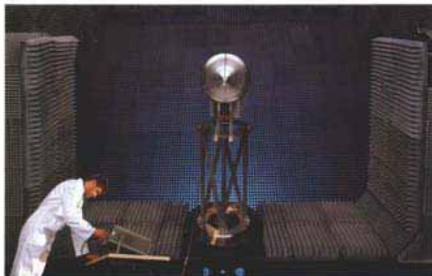
Prüfung der elektrischen Eigenschaften einer Satellitenantenne im reflexionsfreien Meßraum
