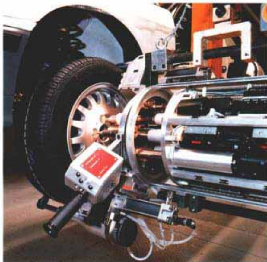
Einsatz rationaler Schraubtechnik von Bosch in der Automobilfertigung.
