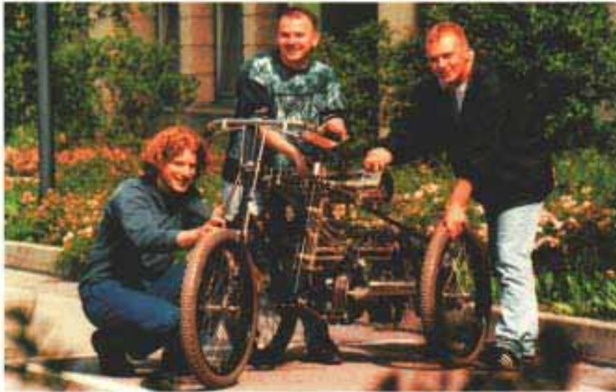
*Die Niederspannungs-Magnetzündung von Bosch brachte 1897 erstmals den Ottomotor eines Fahrzeugs zum Laufen. 100 Jahre später nahmen Lehrlinge dieses Jubiläum zum Anlaß, das legendäre De Dion-Bouton-Dressrad mit dem Zündgerät originalgetreu nachzubauen.*
