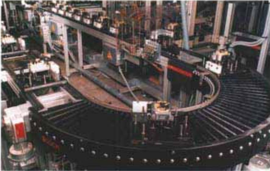
*Komponenten der Bosch-Transfertechnik werden weltweit in Produktion und Montage eingesetzt. Aus den Einzelementen lassen sich einfache Anlagen ebenso installieren wie modular aufgebaute, verkettete Systeme.*
