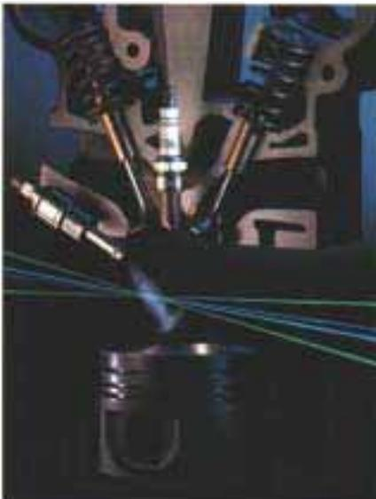
*Für die kraftstoffsparende Benzin-Direktinjektion entwickeln wir derzeit verschiedene Komponenten. Unser Bild zeigt die Analyse der Gemischbildung mit Lasermess-technik.*
