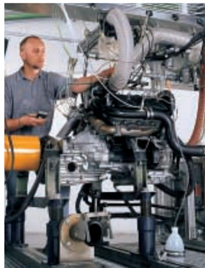
Mesarbeiten an einem Dieselmotor im Werk Stuttgart-Feuerbach. In dem dortigen Prüffeld werden alle Einspritz-Komponenten unter den Bedingungen des realen Motorbetriebs getestet.
