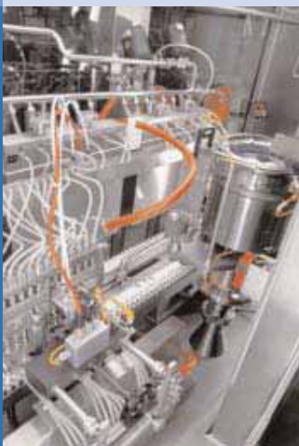
Anspruchsvolle Isolator-technik von Bosch für die Pharmaindustrie: Anlage zum Reinigen, Sterilisieren, Füllen und Verschließen von Ampullen
