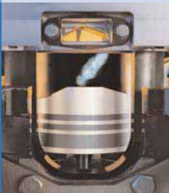
Bei der Benzin-Direkteinspritzung findet die Gemischbildung im Brennraum statt. Wir analysieren die Abläufe an einem Motor mit laser-spektroskopischen Verfahren.
