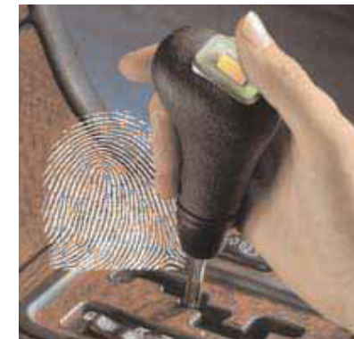
Mittels biometrischer Verfahren wie Fingerabdruckererkennung können Personen anhand physiologischer Merkmale eindeutig erkannt werden. Ein im Fahrwahlschalter integrierter Fingerabdrucksensor ersetzt den Zündschlüssel. Wird der Daumenabdruck des Fahrers als einer der fahrberechtigten Benutzer erkannt, leuchtet das Feld um den Sensor grün auf, und der Motor kann gestartet werden.
