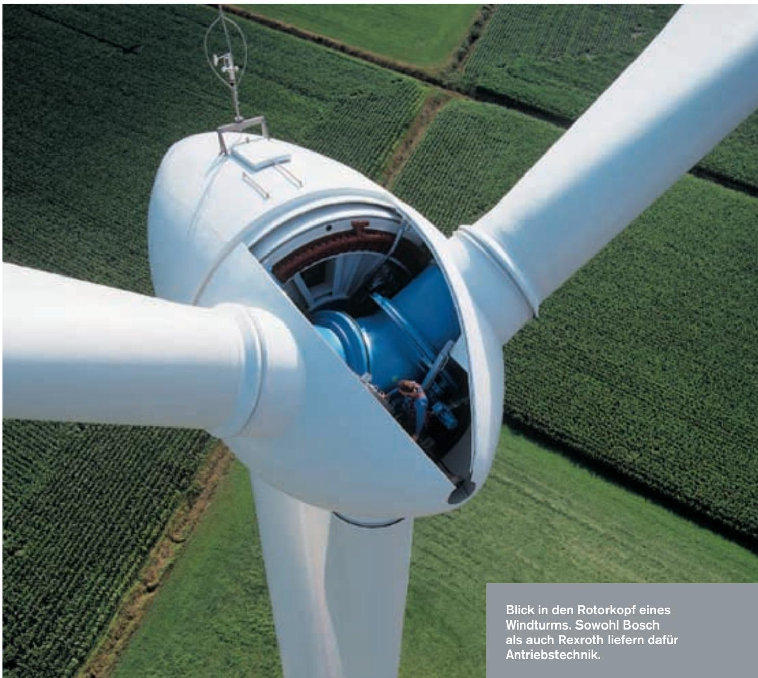
Blick in den Rotorkopf eines Windturms. Sowohl Bosch als auch Rexroth liefern dafür Antriebstechnik.
