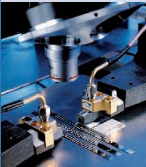
Funktionskontrolle mikroelektronischer Bauteile für die adaptive Fahrgeschwindigkeitsregelung ACC. Wir entwickeln neue Prüfmethoden, um Fertigungsprozesse schneller und sicherer zu machen.
