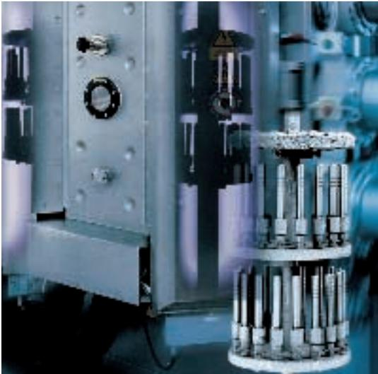
Direkteinspritzsysteme für Dieselmotoren arbeiten mit hohen Drücken. Eine über ein Plasmaverfahren aufgebraute Kohlenstoffschicht sichert die dauerhafte Verschleißfestigkeit einzelner Komponenten.
