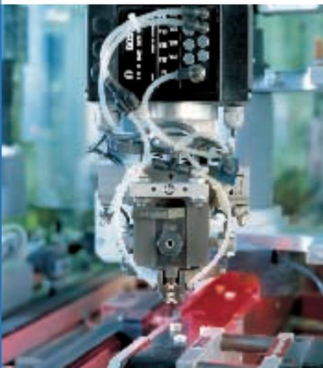
Unsere neue Roboter-Generation. Das Besondere bei diesem Montageeinsatz ist die ungeordnete Zuführung der Teile, deren Ausgangslage durch das integrierte Bosch-Bildverarbeitungssystem ermittelt wird.
