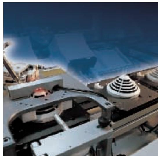
**Abschlussprüfung für Sicherheit und Zuverlässigkeit: Bevor unsere Brandmelder das Werk verlassen, schließen wir jedes einzelne Gerät an eine Gefahrenmeldeanlage an und testen es auf alle Funktionen.**
