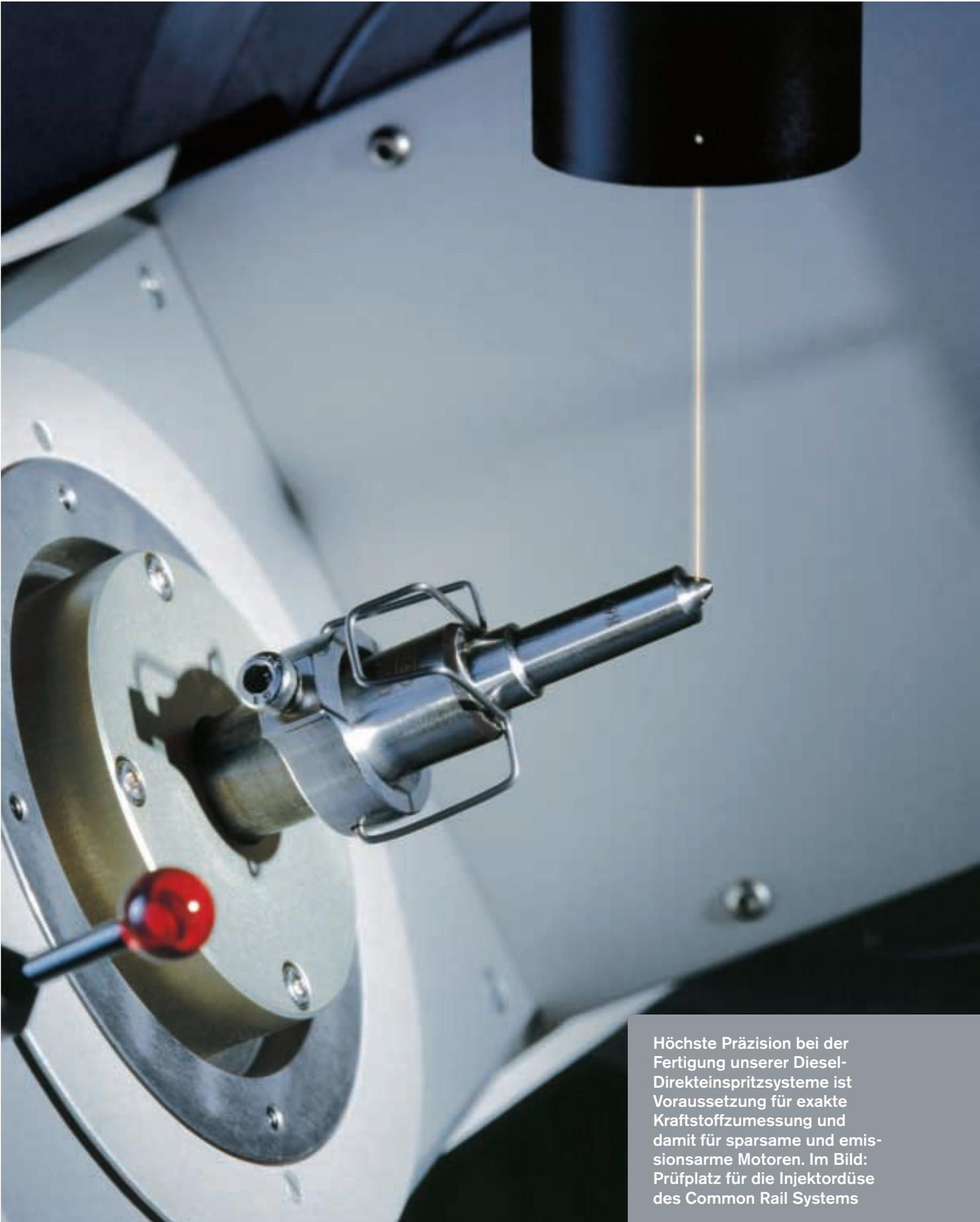
Höchste Präzision bei der Fertigung unserer Diesel-Direkteinspritzsysteme ist Voraussetzung für exakte Kraftstoffzumessung und damit für sparsame und emissionsarme Motoren. Im Bild: Prüfplatz für die Injektordüse des Common Rail Systems
