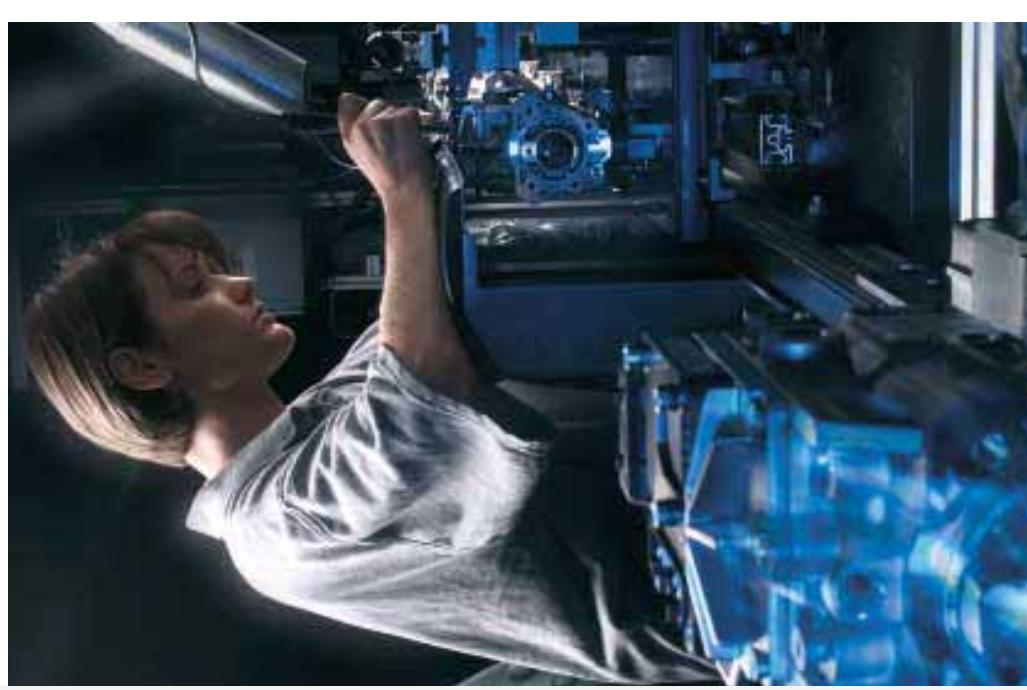
▼ Prüfung eines Hochdruck-Dieseleinspritzsystems. Neben der Radialkolben-Verteilerpumpe fertigen wir vor allem Common Rail und Unit Injector Systeme. Alle drei Techniken ermöglichen durch die von uns entwickelte direkte Hochdruckeinspritzung das hohe Drehmoment und den niedrigen Verbrauch moderner Dieselmotoren.
