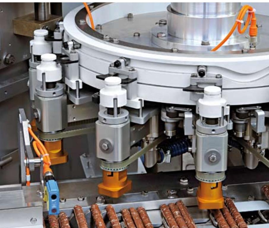
Speziell für die Qualitätsbedürfnisse der Schokoladenindustrie entwickelten wir ein Zuführungsrad für die Verarbeitung von Riegeln bei Hochgeschwindigkeit. Das neue Zuführungsrad, mit dem bis zu 800 Packungen pro Minute verarbeitet werden, ist für verschiedene Anwendungen konfigurierbar und arbeitet besonders produktschonend.
