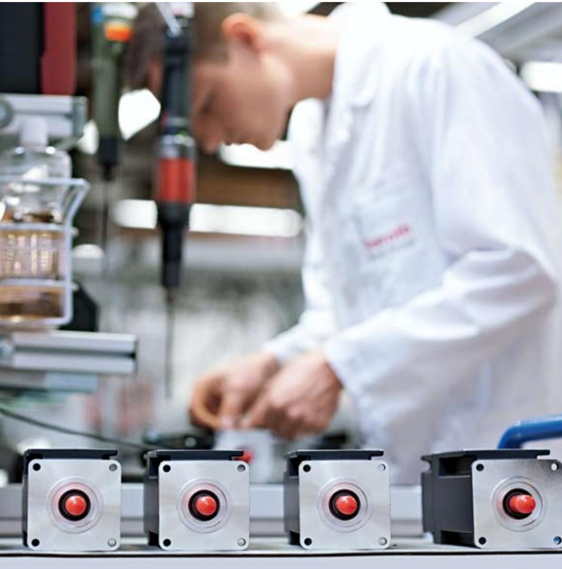
Die jüngste Innovation in der Servo-Antriebstechnik von Bosch Rexroth ist eine Motor-Regler-Kombination. Das System ist so kompakt, dass Anwender den Verkabelungsaufwand um bis zu 85% und das Schaltschrankvolumen um bis zu 70% verringern können.
