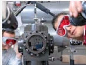
Versuchsaufbau für die Benzin-Direkt-einspritzung. Mit einem speziellen Ultraviolett-Laser können wir das Einspritzverhalten und den Verdampfungsprozess des Kraftstoffs sichtbar machen. Mit einer hoch verstärkenden UV-Kamera werden die Prozesse im Bild festgehalten.
