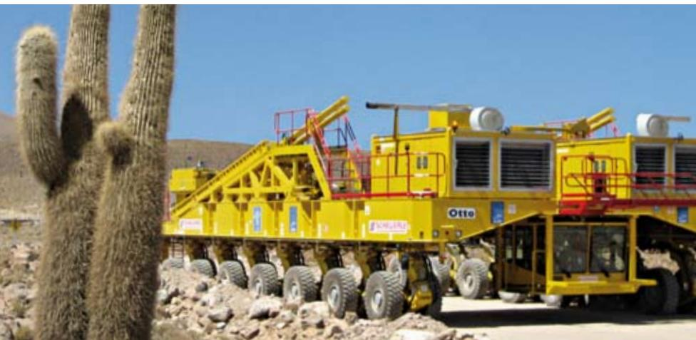
**Kraft für die Höhe:** Verstellmotoren und Verstellpumpen von Bosch Rexroth treiben die 14 Achsen dieses Schwertransporters an. Der Fahrtrieb ist für hohe Stabilität und Robustheit ausgelegt, denn die Spezialfahrzeuge werden unter extremen Bedingungen eingesetzt. Sie transportieren insgesamt 66 bis zu 115 Tonnen schwere Parabolspiegel auf ein 5100 Meter hohes Plateau in der Atacama-Wüste in Chile, wo bis 2012 die modernste Radioteleskopanlage der Welt entstehen wird.
