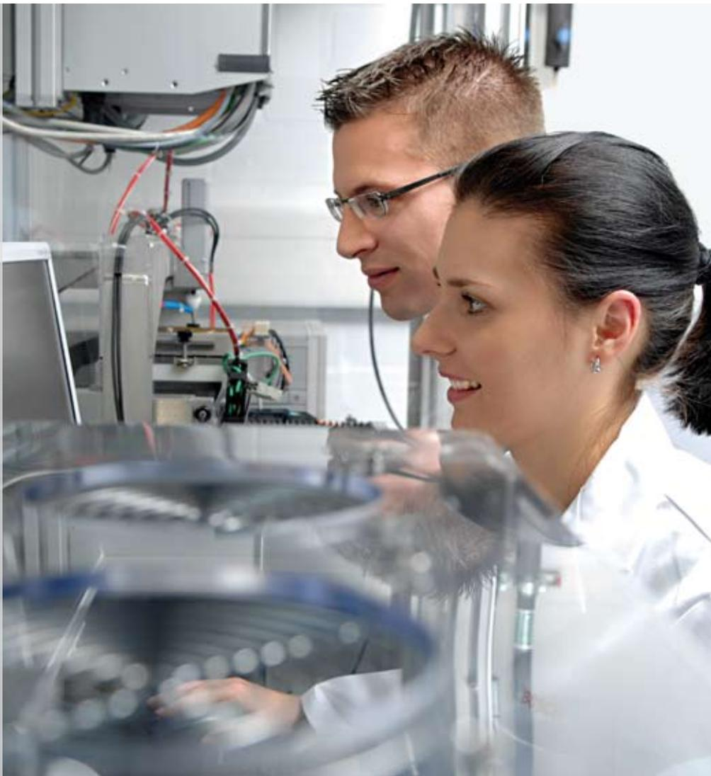
Als Antrieb hochpräziser Einspritzventile verwenden wir piezokeramische Aktoren. Die Leistungsfähigkeit der Piezoaktoren wird im Wesentlichen durch deren Materialzusammensetzung bestimmt. Daher führen wir im Rahmen der Werkstoffentwicklung umfangreiche Tests der elementaren Materialeigenschaften durch. Unser Bild zeigt eine Prüfeinrichtung zur Charakterisierung piezoelektrischer Massivkeramikscheiben.
