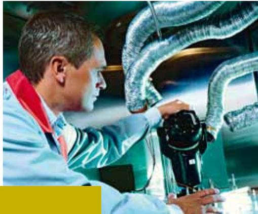
Der Überwachung von Innenstädten und Fußgängerzonen dient unsere Hochgeschwindigkeitskamera MIC Series 500. Da sie häufig wechselnden Witterungsverhältnissen ausgesetzt ist, braucht sie ein robustes Aluminiumgehäuse. Im Prüflabor wird die Widerstandsfähigkeit der Kamera getestet.
