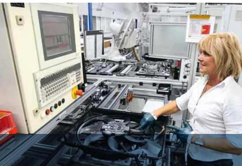
Der Geschäftsbereich Electrical Drives entwickelt und fertigt elektrische Kleinmotoren für Anwendungen im Kfz-Bereich. Im Werk Bühl werden jährlich mehr als 72 Millionen Motoren gefertigt. Das Bild zeigt eine Mitarbeiterin bei der Sichtprüfung des Motorkühlgebläses in Bühl.
