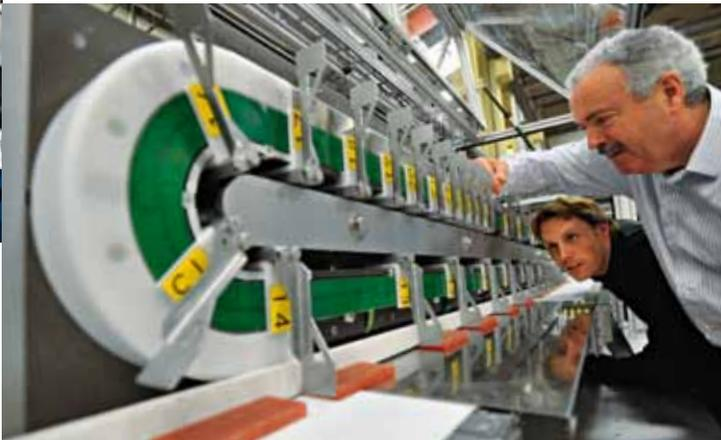
Für die Verpackung empfindlicher Nahrungsmittel und Süßwaren haben wir ein völlig neuartiges Transportsystem entwickelt. Das kompakte Läufer-System sorgt dafür, dass die Packstücke vor der Verpackung beschleunigt und in gleichmäßige Abstände gebracht werden. Dafür waren bisher sehr aufwändige Bandsysteme oder Roboter notwendig.
