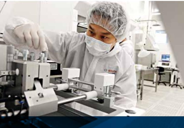
Forschungslabor zur Herstellung organischer Photovoltaikzellen in unserer Südostasien-Zentrale Singapur. Im Bild: Einrichten einer Siebdruckmaschine.
