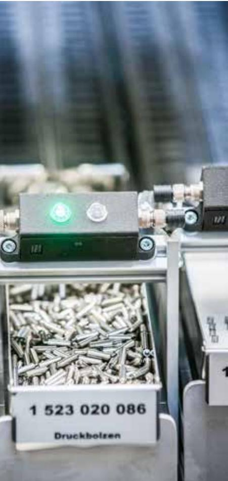
*Werden unterschiedliche Teile im schnellen Wechsel gefertigt, erleichtern grüne Signale an den Greifbehältern die Arbeit.*
