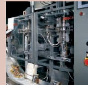
*Maschine zur Fertigung von Schlauchbeutelverpackungen*
