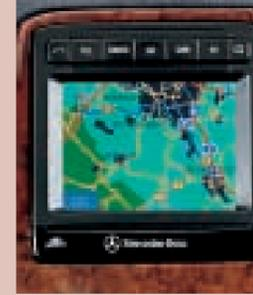
Wir entwickelten das elektronische Fahrereinformationssystem Comand (Cockpit Management and Data System). Es umfaßt ein dynamisches Navigationssystem, das seine Zielführung an die Verkehrslage anpaßt, sowie zahlreiche Bedienfunktionen
