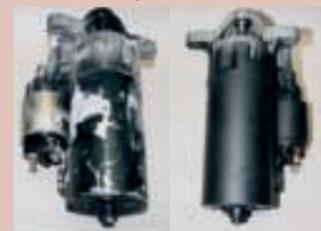
Starter bei Anlieferung (links) und nach der Serieninstandsetzung (rechts)
