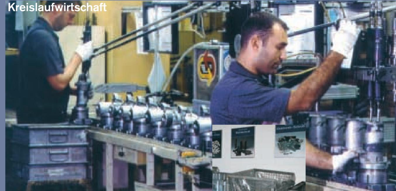
In Recyclingzentren werden die im gesamten Bundesgebiet gesammelten Altelektrowerkzeuge und Akkumulatoren demontiert und die Bauteile recycelt; ebenso die speziellen Kunststoffe alter Telefongesysteme des Unternehmensbereiches Kommunikationstechnik. Aus ihnen entstehen z. B. Tragekoffer für neue Elektrowerkzeuge. Seit 1994 nehmen wir auch Haushaltsgeräte zurück; 1998 gelangten so 1584 t Metalle und 242 t Kunststoffe wieder in den Wirtschaftskreislauf.
