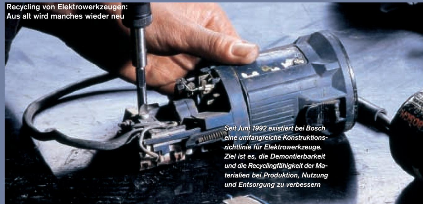
*Seit Juni 1992 existiert bei Bosch eine umfangreiche Konstruktionsrichtlinie für Elektrowerkzeuge. Ziel ist es, die Demontierbarkeit und die Recyclingfähigkeit der Materialien bei Produktion, Nutzung und Entsorgung zu verbessern*
