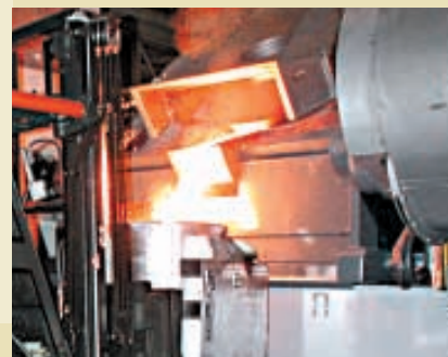
Eisenschmelzung im neuen Mittelfrequenzofen von Bosch Rexroth ▣
