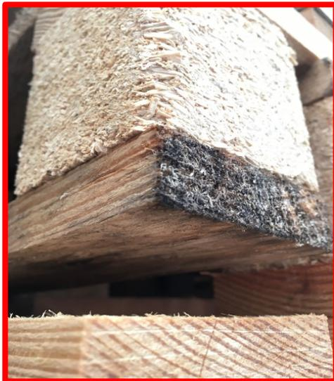
**Abbildung 19:** N.i.O. Schimmel, Schwamm, Trockenfäule
