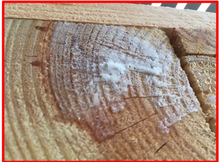
**Abbildung 16:** N.i.O. Schimmel, Schwamm, Trockenfäule
