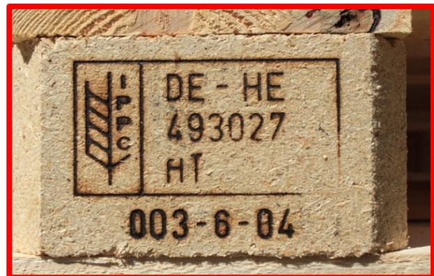
**Abbildung 10:** N.i.O.: Rahmen nicht durchgängig, HT-Kennzeichnung nicht klar erkennbar
