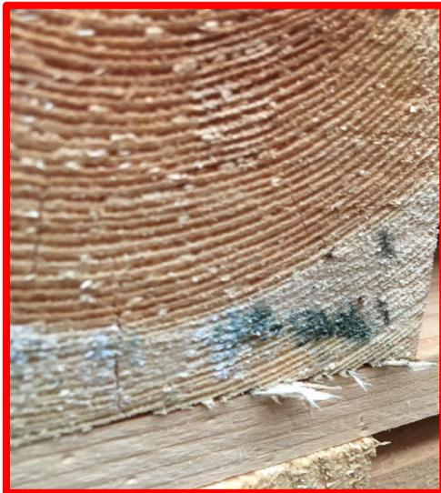
**Abbildung 17:** N.i.O. Schimmel, Schwamm, Trockenfäule
