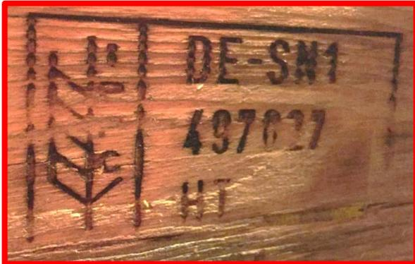
**Abbildung 3:** N.i.O.: Länderkennung und Lieferantenummer nicht lesbar, Rahmen nicht durchgängig, IPPC Logo unvollständig
