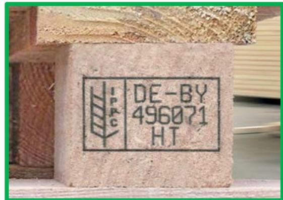
**Abbildung 8:** Kennzeichnung i.O.
