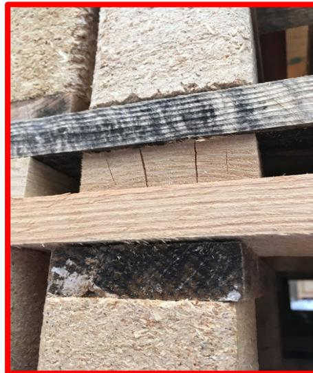
**Abbildung 18:** N.i.O. Schimmel, Schwamm, Trockenfäule
