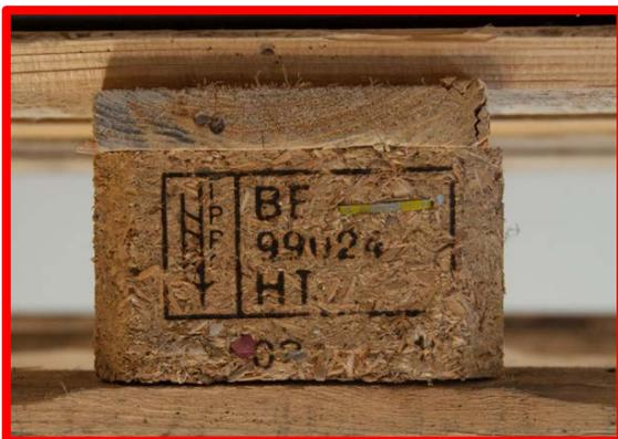
**Abbildung 9:** N.i.O.: Länderkennung und Lieferantenummer nicht lesbar, Rahmen nicht durchgängig, IPPC Logo unvollständig
