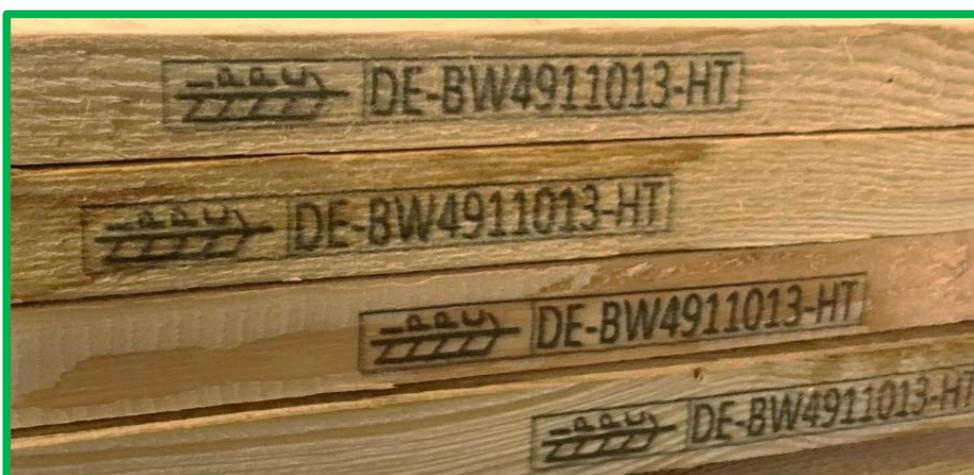
Abbildung 2: Kennzeichnung i.O.
