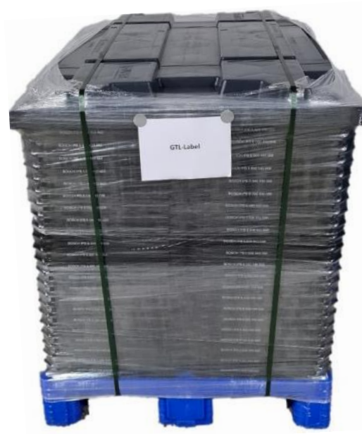
Abbildung 1: Korrekt foliertes Gebinde
