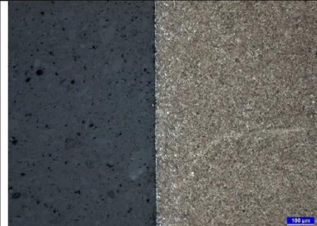
Bild 4: Vergütungsgefüge Rand
