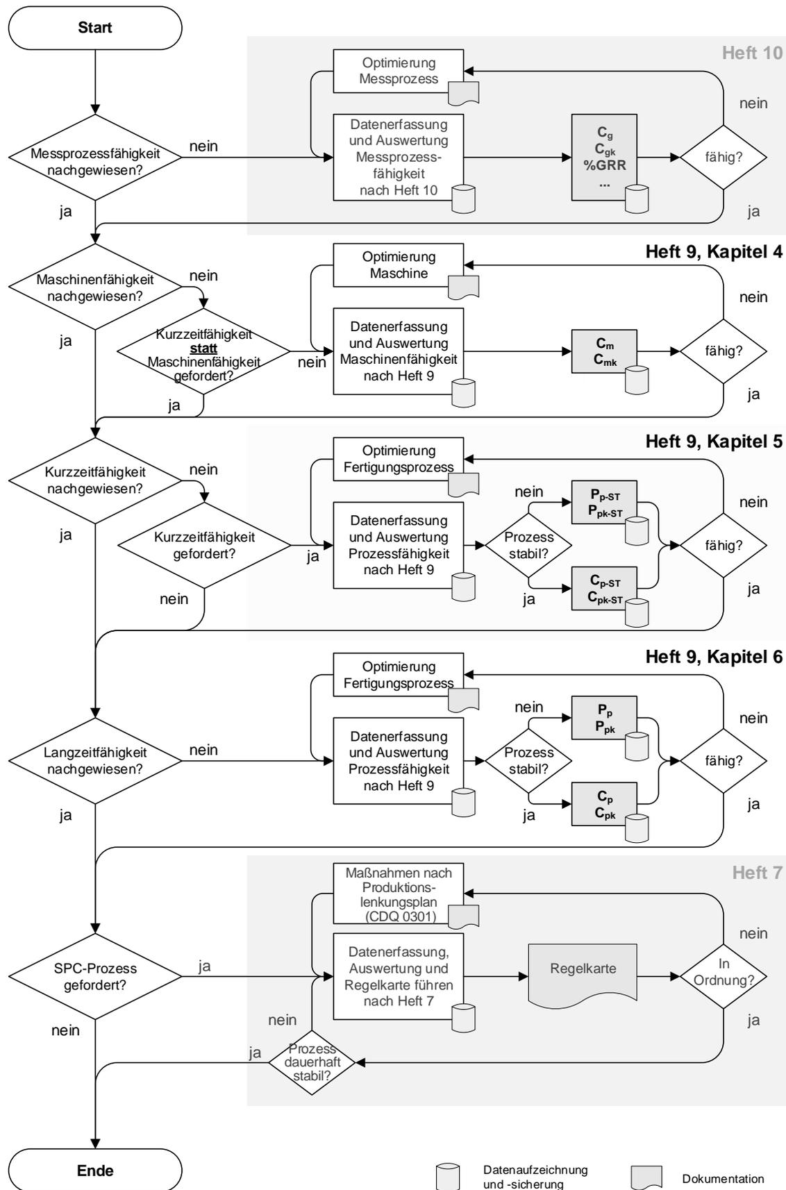
Abbildung 1: Ablauf der Fähigkeitsuntersuchungen und Prozessüberwachung
