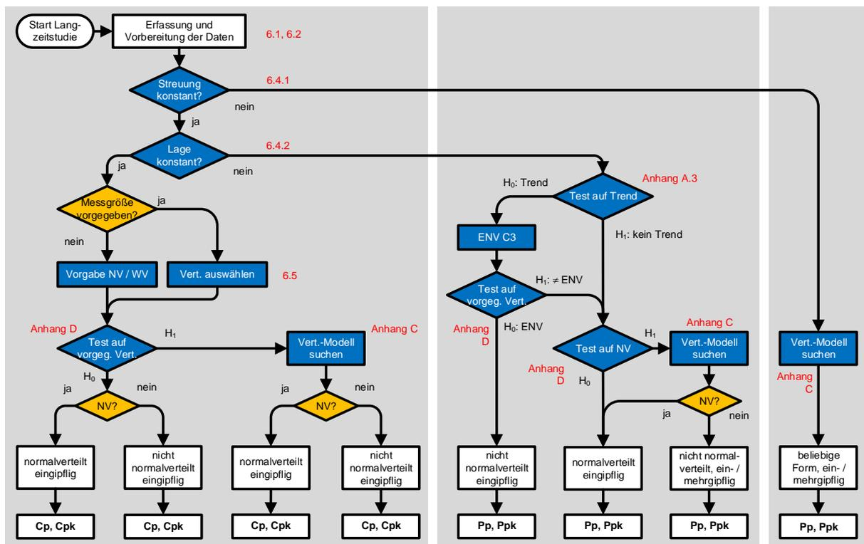
Abbildung 4: Auswertekonfiguration zur Prozessfähigkeitsuntersuchung
