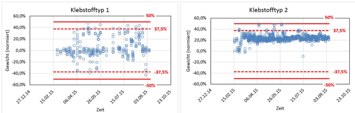
Abbildung 49: Zeitreihendiagramme „Klebstoffgewicht“ (Fertigungslinie 3 ausgeblendet)
