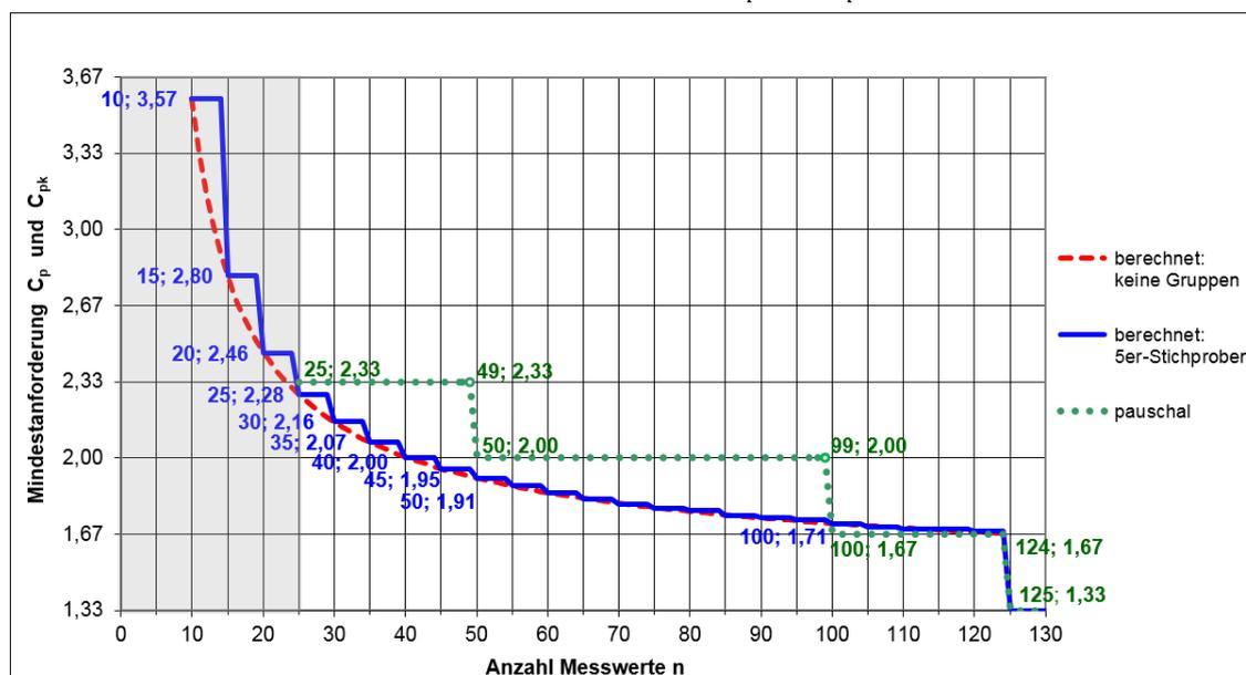
Abbildung 44: Mindestwerte für  $C_p$  und  $C_{pk}$  bei weniger als 125 verfügbaren Messwerten
