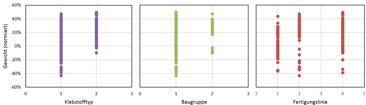
Abbildung 50: Klebstoffgewicht stratifiziert (Fertigungslinie 3 ausgeblendet)
