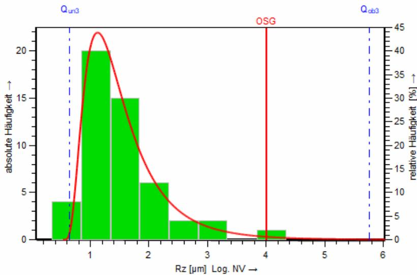
Abbildung 18: Beispiel „Rauheit“; Urwertdiagramm und Histogramm mit Verteilungsfunktion
