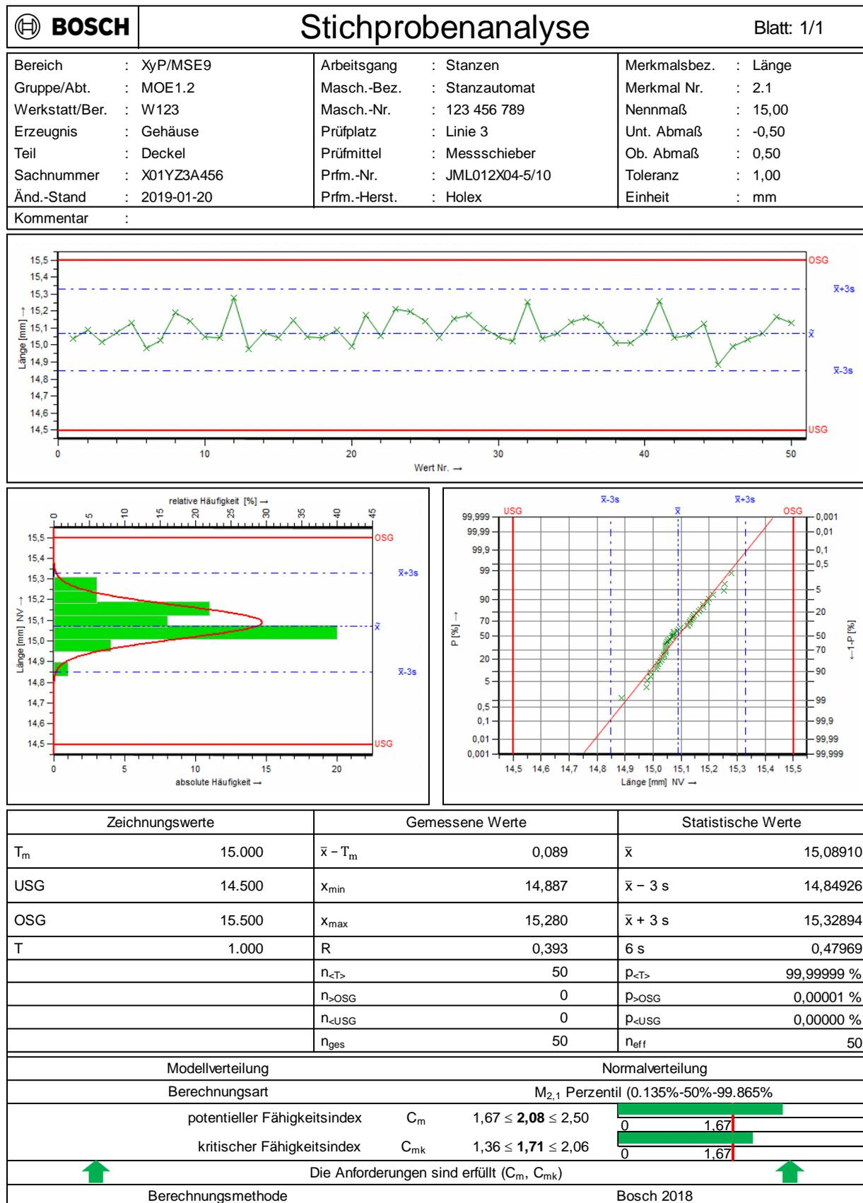
Abbildung 21: Inhalte des RB-Standardberichts zur Maschinenfähigkeit (qs-STAT®)
