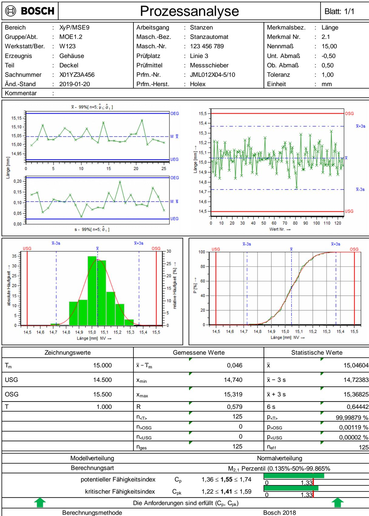
Abbildung 22: Inhalte des RB-Standardberichts zur Prozessfähigkeit (qs-STAT®)
