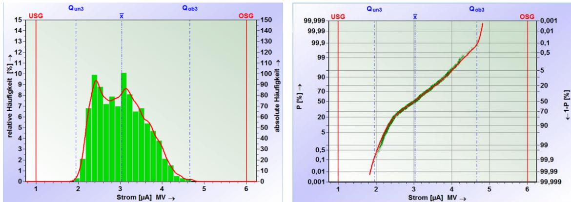
Abbildung 33: Ermittlung der Prozessstreuung mittels Mischverteilung
