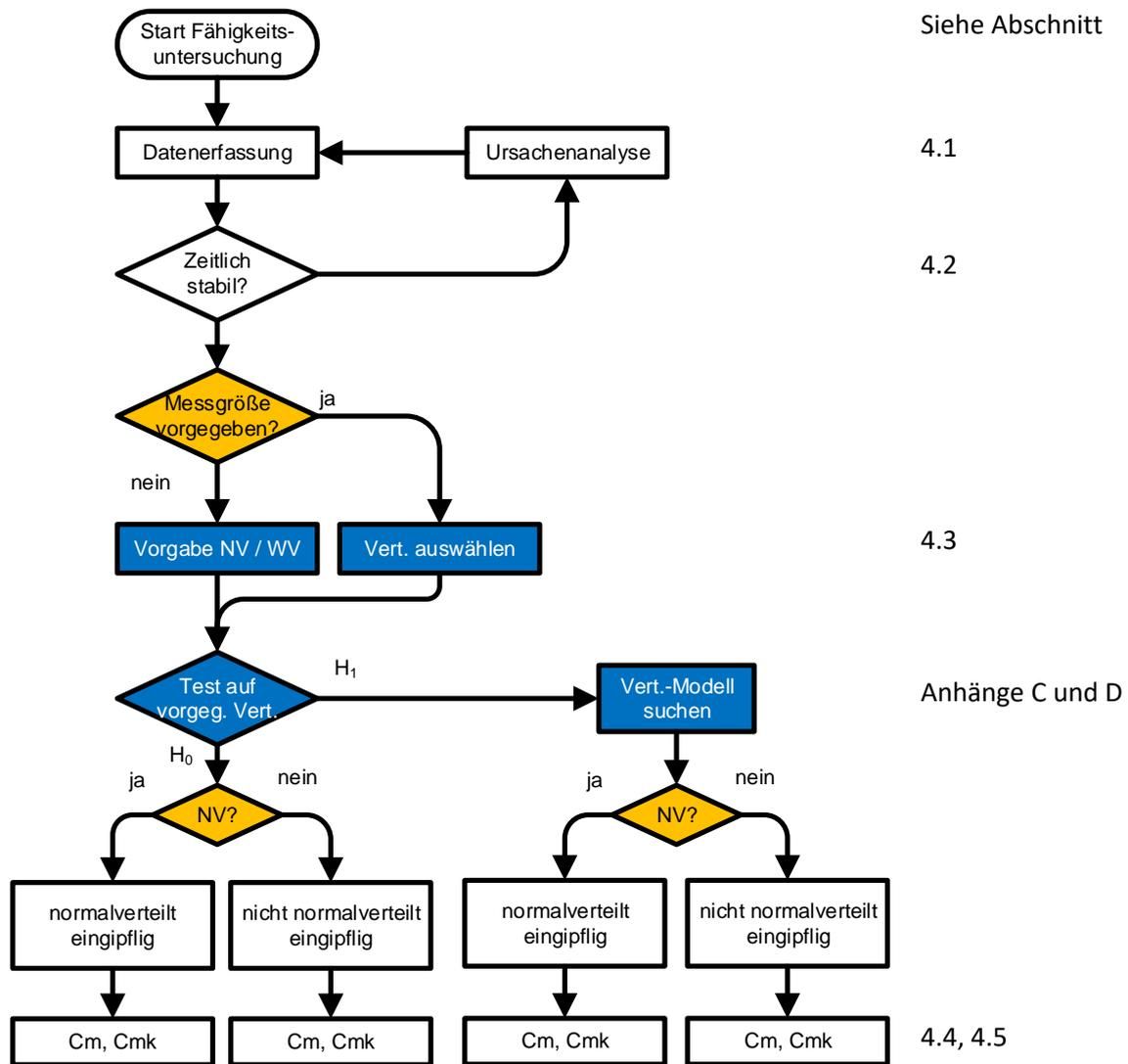
Abbildung 2: Ablauf einer Maschinenfähigkeitsstudie
