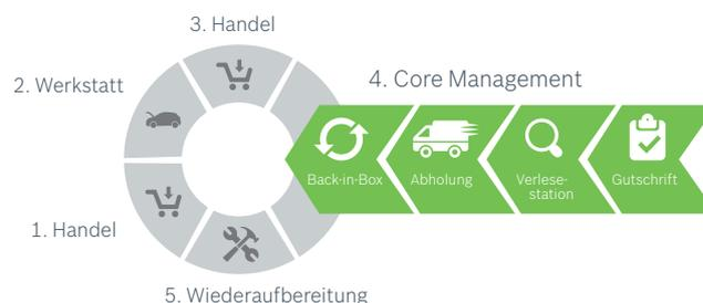
Die aus Fahrzeugen ausgebauten Altteile werden strukturiert aus dem Markt zurückgenommen, identifiziert und sortiert. Sofern diese den technischen Anforderungen entsprechen, gelangen sie an die Produktion zur Aufbereitung. Um einen reibungslosen Rücknahmeprozess sicherzustellen, hat Bosch 2016 die Tochterfirma Circular Economy Solutions gegründet. Unter der Servicemarke CoremanNet führte sie 2016 etwa 2,5 Millionen Teile im Kreislaufwirtschaftsprozess aus dem Markt zurück.
